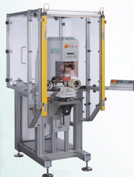
Machine MDX 100 sur bâti au sol avec Cartérisation et Barrière immatérielle de sécurité.
